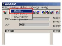
4. 「シリアルポートの設定」で「COM」を選択し、接続している COM ポートを設定し OK します。
