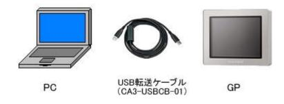
1) GP-3300T/S/L、GP-3301S/L、ST-3301T/S/B に USB 転送ケーブルを接続します。
